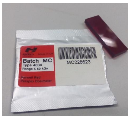
Figura 2-6. Dosímetro de perspex utilizado na determinação da dose absorvida.
