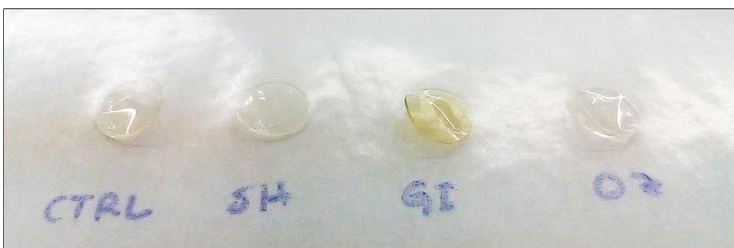
Figura 4.3 – Transmitância do hidrogel carregado com levofloxacina (A), diclofenac (B), timolol (C) clorhexidina (D), antes e depois dos diferentes processos de esterilização: calor húmido (SH), irradiação gama (GI) e ozonização (OZ).
