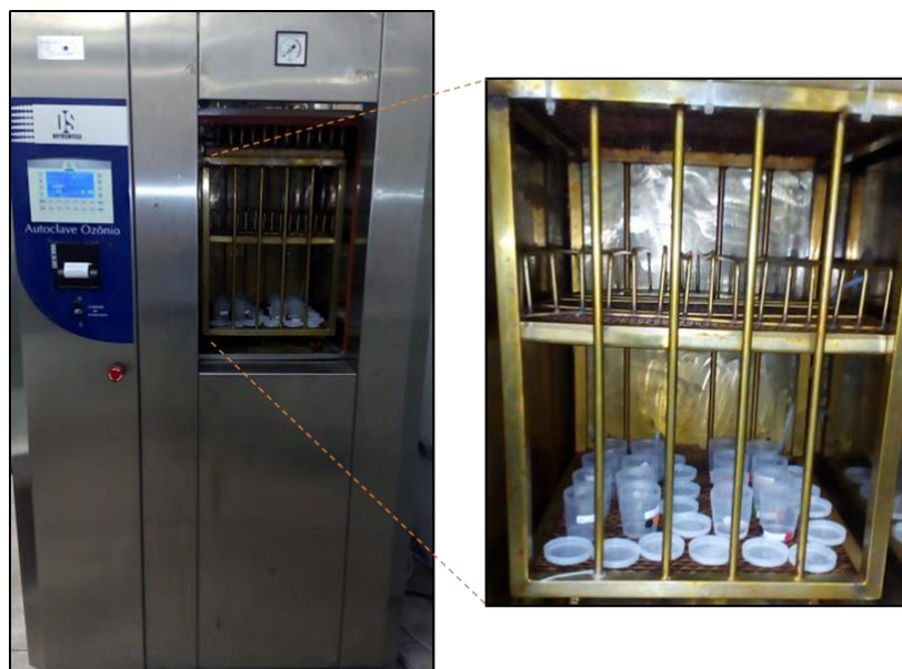
Figura 2-3. Esterilizador de Ozono desenvolvido pela Brasil Ozônio. Detalhe evidenciando o interior da câmara de esterilização e o acondicionamento das amostras.
